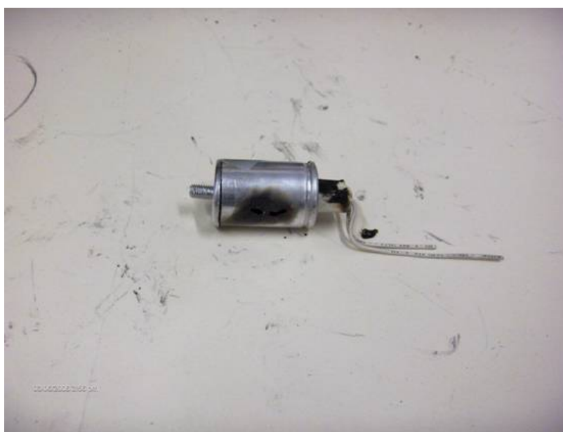
Figur 3.2: Feil i kondensator til lysrør.
